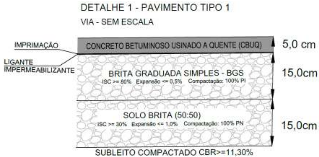
Figura 13 - Pavimento Tipo Via
